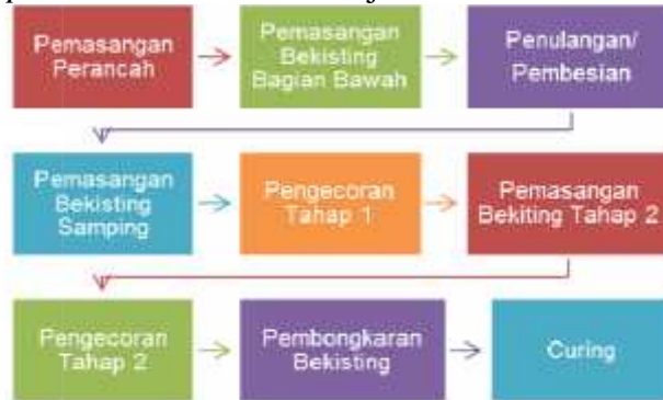
Gambar 5. Tahapan Pelaksanaan Pekerjaan Pier head Cast in situ (Hasil olahan,2016)
