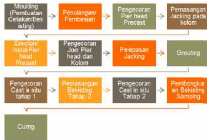
Gambar 9. Tahapan Pelaksanaan Pekerjaan Pier head Cast in situ (Hasil Olahan,2016)
