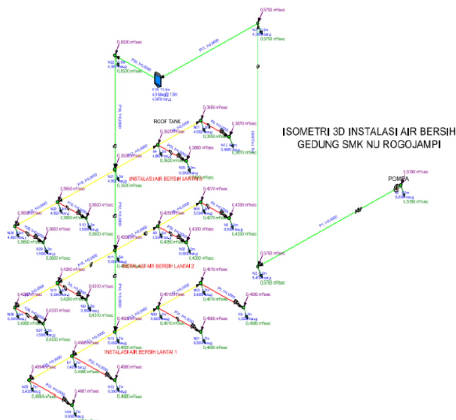
Gambar 1. Simulasi Kondisi Eksisting
