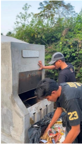
Gambar 5 Implementasi Rocket stove untuk Sampah Kering
